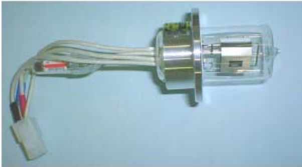
Рис. 34 Дейтериевая лампа с разъемом и счетчиком времени работы
