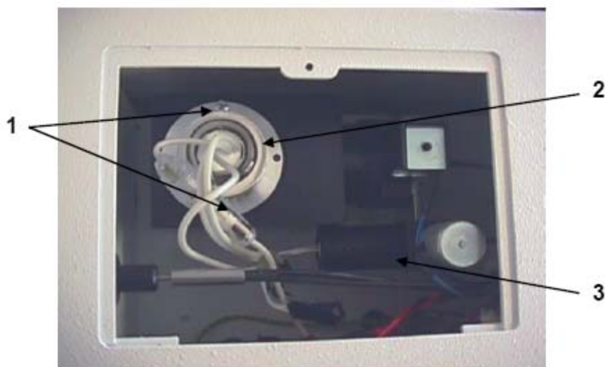
Рис. 35 Блок ламп: дейтериевая лампа (2), галогеновая лампа (3)
