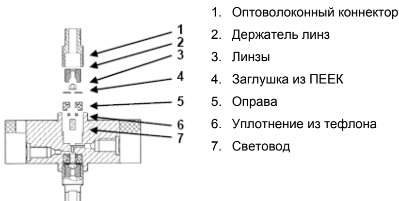
Рис. 37 Вид аналитической проточной ячейки 3 мм для S2800 в разборе
