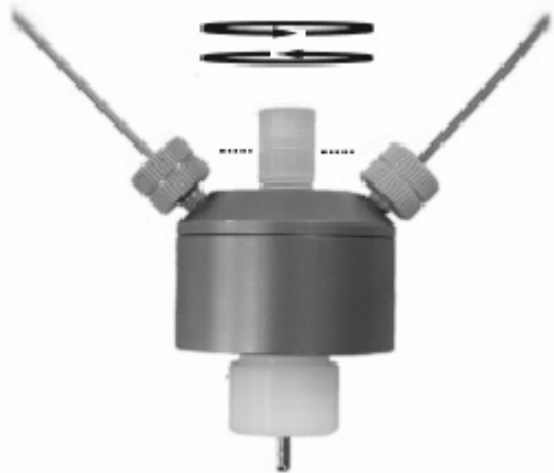
Рис.12 Вентиляция измерительной ячейки
