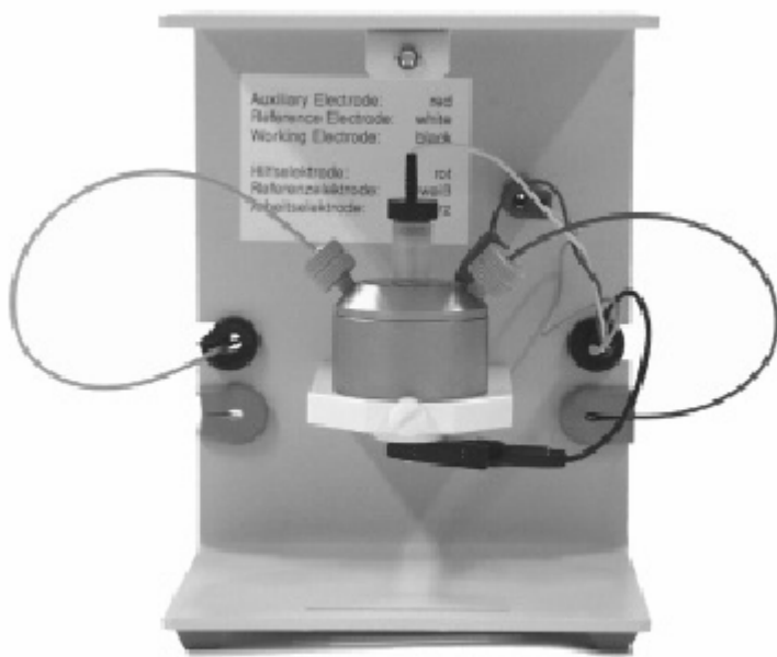
Рис.5 Электрохимическая измерительная ячейка EC4000
