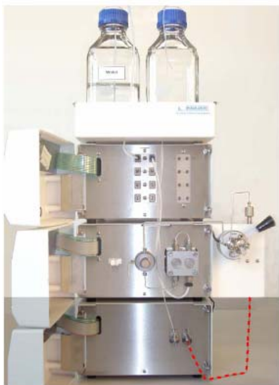
Рис. 11 Капиллярные подсоединения детектора
