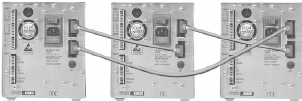
Рис. 23 Схема подключения трех инструментов
