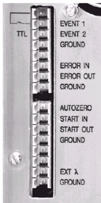
Рис. 22 Разъемы внешнего управления и разъемы Event
