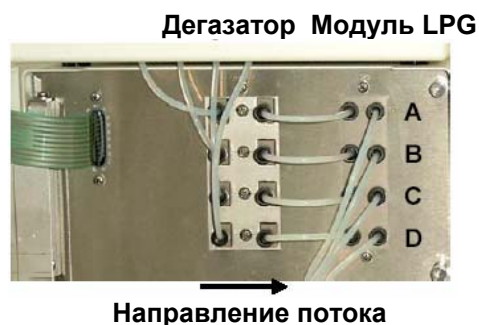
Рис. 5 Подсоединение модуля дегазатора в аналитическом исполнении
