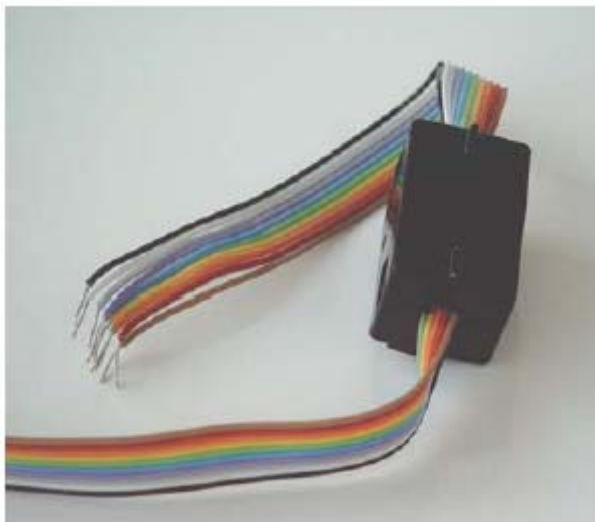
Рис. 23 Присоединение ферритового кольца к кабелю
