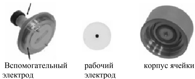
Рис.6 Компоненты ячейки: электрод сравнения, рабочий и вспомогательный электроды
